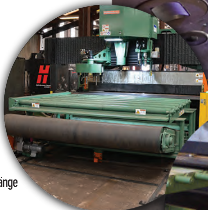
Das seitliche Entladesystem
